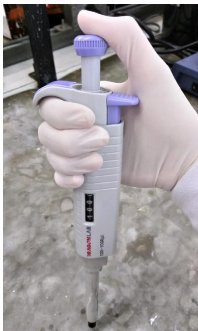
Figura 51: modo correto de se segurar a pipeta.
