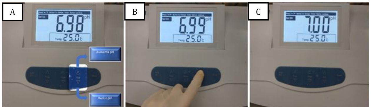
Figura 40: A: demonstração do local das setas; B: setas do botão “Std” sendo pressionadas até que o visor apresente o pH 7; C: correspondência do valor à solução padrão.
