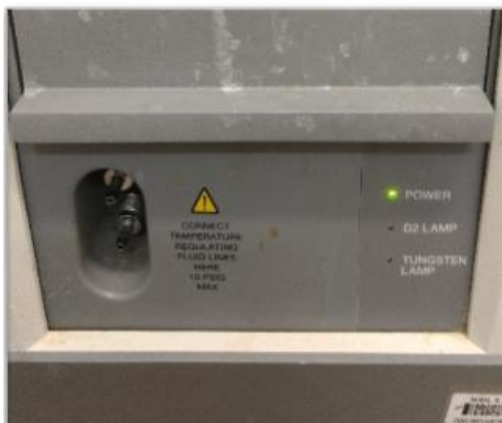
Figura 63: led verde "POWER" indicando que o espectrofotômetro está ligado.
