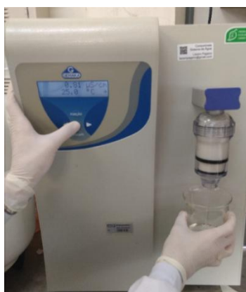
Figura 7: equipamento de produção de água deionizada. Para usá-lo, pressionar o local indicado com o polegar para que se inicie a liberação da água. Pressionar novamente para cessar a saída de água.
