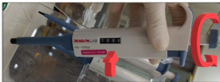
Figura 50: ao rotacionar o botão giratório, o valor indicado no leitor volumétrico será alterado.
