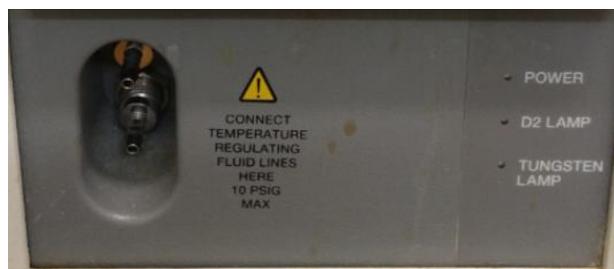
Figura 89: observar todos os LEDs apagados na parte frontal do aparelho.
