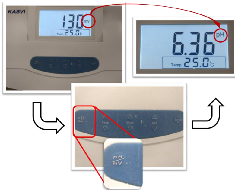
Figura 32: sequência que ilustra a mudança de mV para pH.
