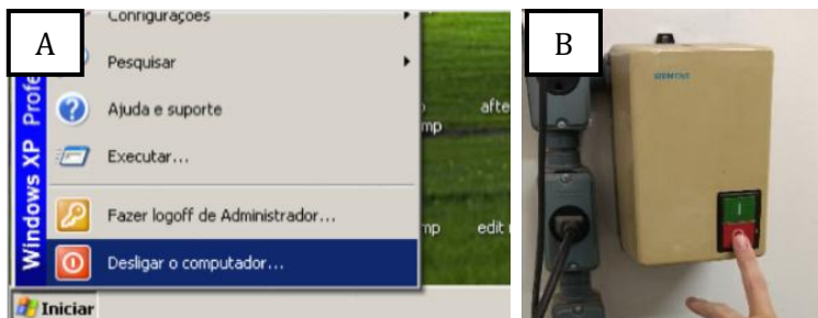
Figura 88: primeiro, deve-se desligar o computador (A) para, em seguida, desligar o espectrofotômetro no quadro de força (B).
