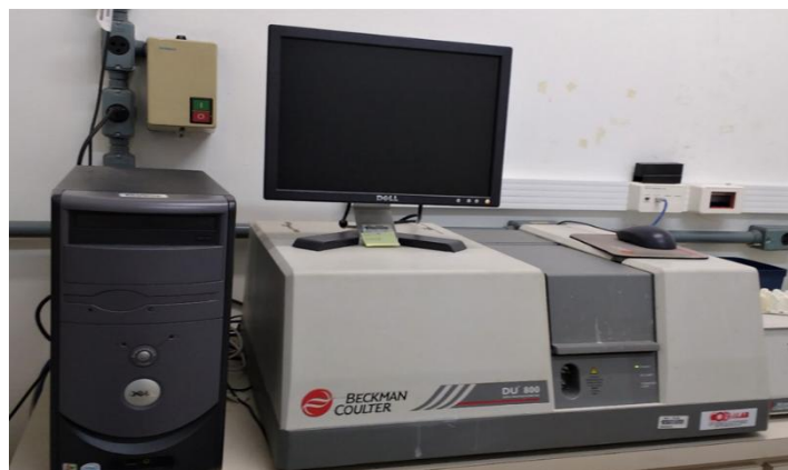
Figura 59: vista frontal do espectrofotômetro Beckman Coulter DU-800 e do PC ao qual está acoplado.
