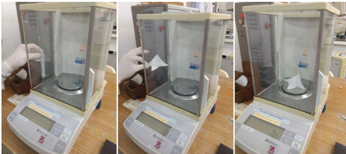
Figura 15: passo a passo da inserção do papel de seda sobre o prato da balança.
