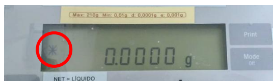
Figura 16: símbolo * ao canto esquerdo do painel.
