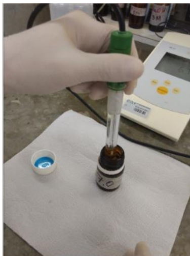
Figura 44: ponta do eletrodo sendo inserida na solução padrão de pH = 7.
