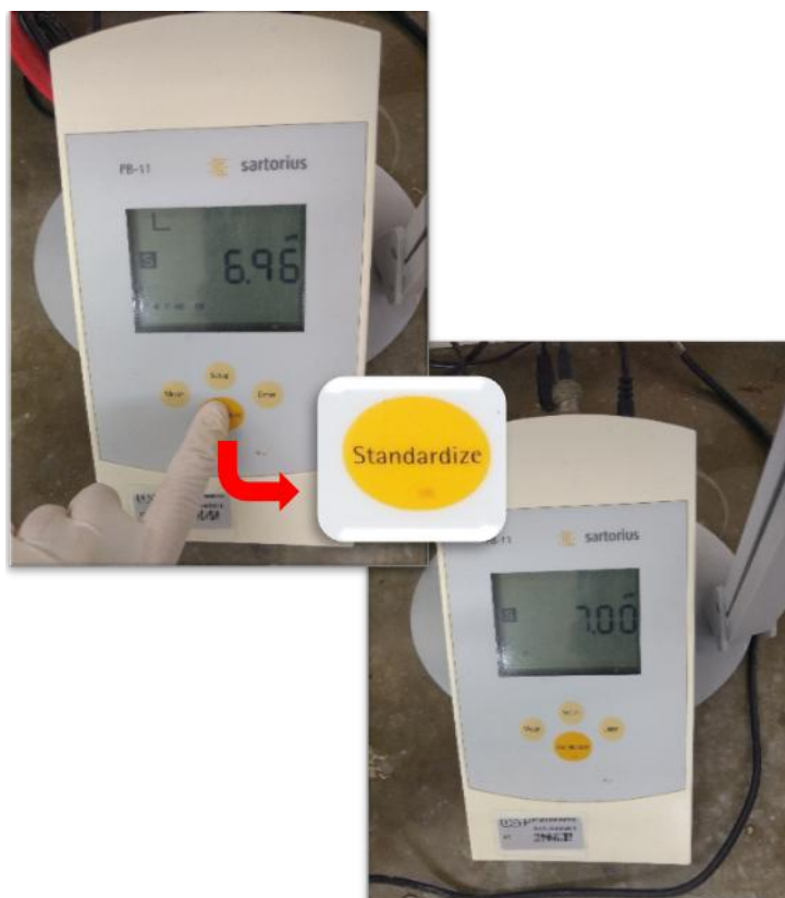
Figura 46: o botão "Standardize" sendo pressionado para calibrar o aparelho com o valor obtido na leitura da solução padrão.
