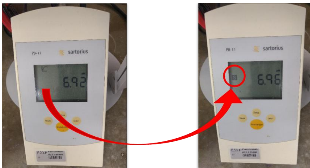
Figura 45: estabilização da leitura de pH da solução padrão, com surgimento do símbolo “S” no visor.
